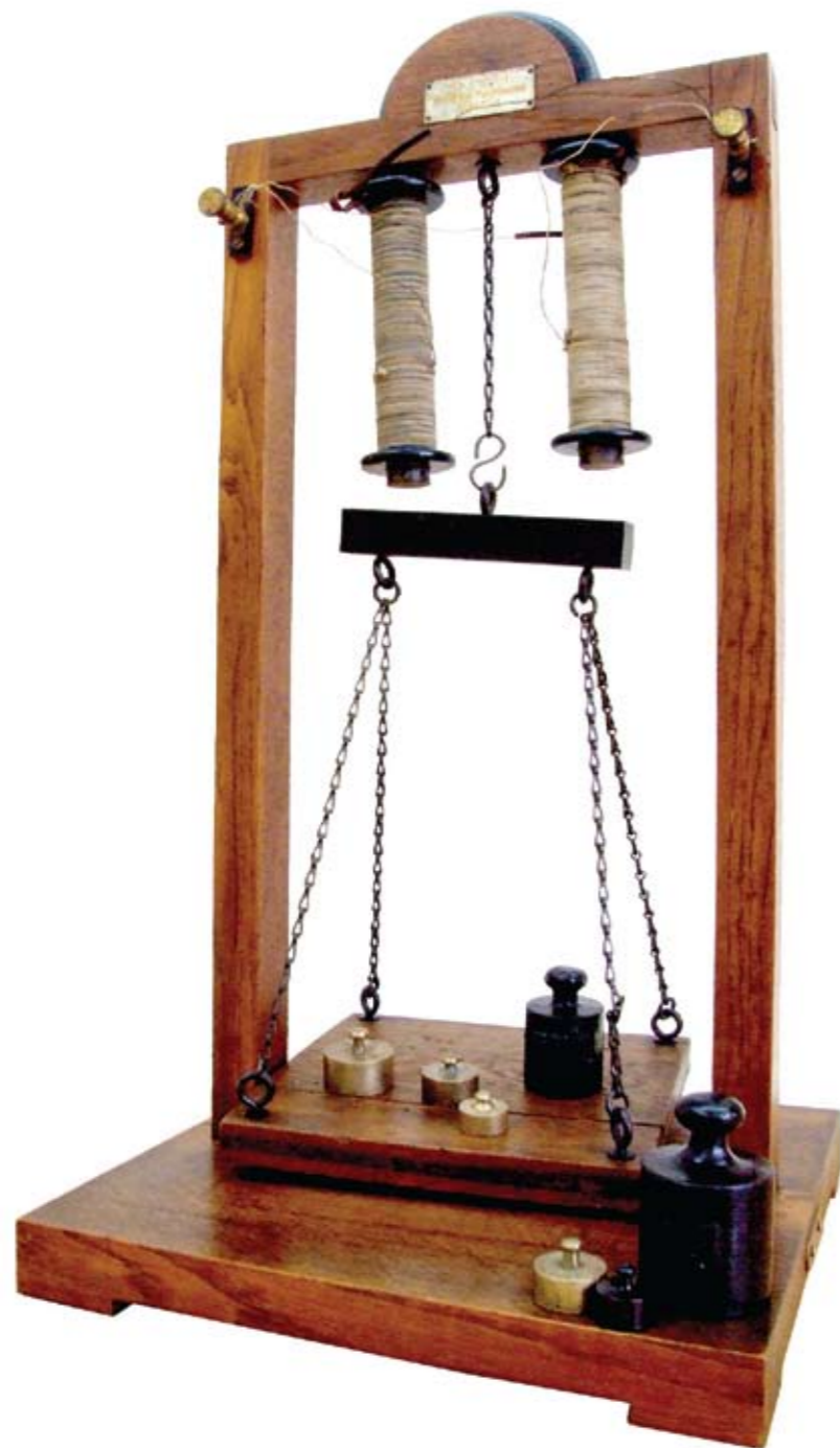
Електромагнет са котвом и тасом (око 1905) An electromagnet with a pintle and pan (circa 1905)
