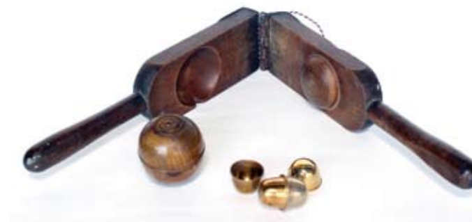
Ручна преса за трохисце и прибор за израду пилула A manual press for trochiscs and accessories for making pills
